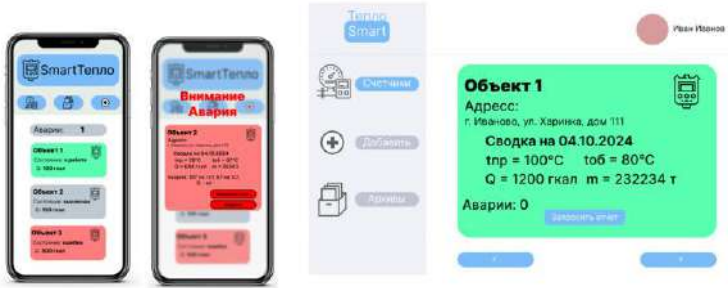
Рис. 1. Мобильное приложение для передачи данных с тепловычислителя
