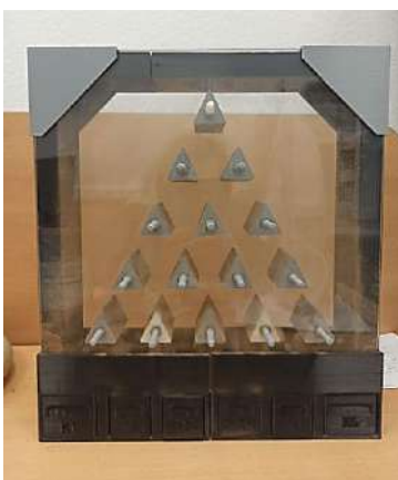
Рис. 1. Установка многоступенчатых гравитационных классификаторов многопродуктового типа
