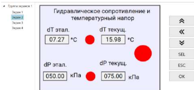
Рис. 4. Интерфейс экрана 2 PR205 – вывод значений эталонных и текущих значений ТН и ГС (случай, когда оба «текущих» значения отклоняются от «эталонных» на 30%)
