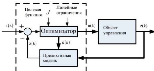
Рис. 1. Схема системы управления с предиктивной моделью
