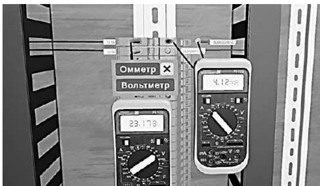
Рис. 3. Подключение мультиметра в промежуточном клеммнике
