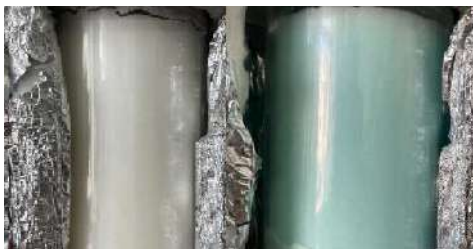
Рис. 2. Внешний вид рабочего тела - стеариновой кислоты слева - в начале эксперимента, справа - по окончании эксперимента
