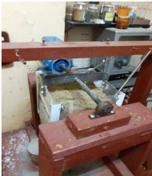
Рис. 2. Универсальная лабораторная установка для грохочения и перемешивания гравийнопесчаных смесей
