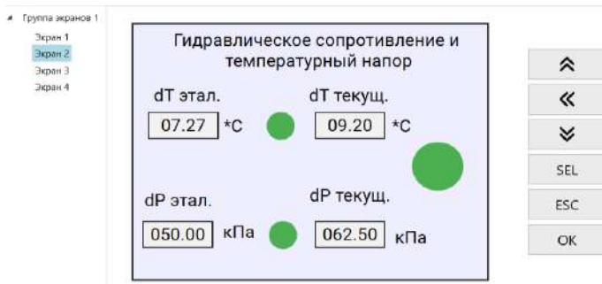
Рис. 3. Интерфейс экрана 2 ПР205 – вывод значений эталонных и текущих значений ТН и ГС (случай, когда оба «текущих» значения не отклоняются от «эталонных» на 30%)
