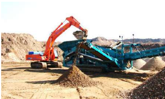
Рис. 1. Процесс предварительного грохочения сыпучих материалов в карьере
